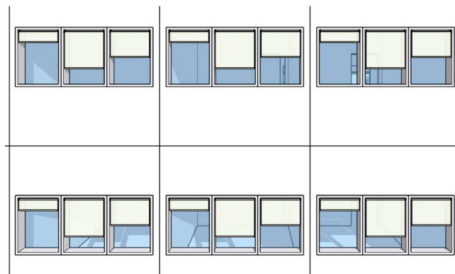
Figure 24 - Vue en perspective : Installation de stores réglables à l'extérieur
